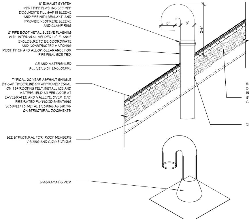
R49 SPRAY FOAM (TYP.) - STAYCELL 302/STAYCELL ONE STEP 255 INTUMESCENT SPRAY FOAM INSULATION - SYSTEM (HYBRID SYSTEM) OR ICYNENE CLASSIC MAX
