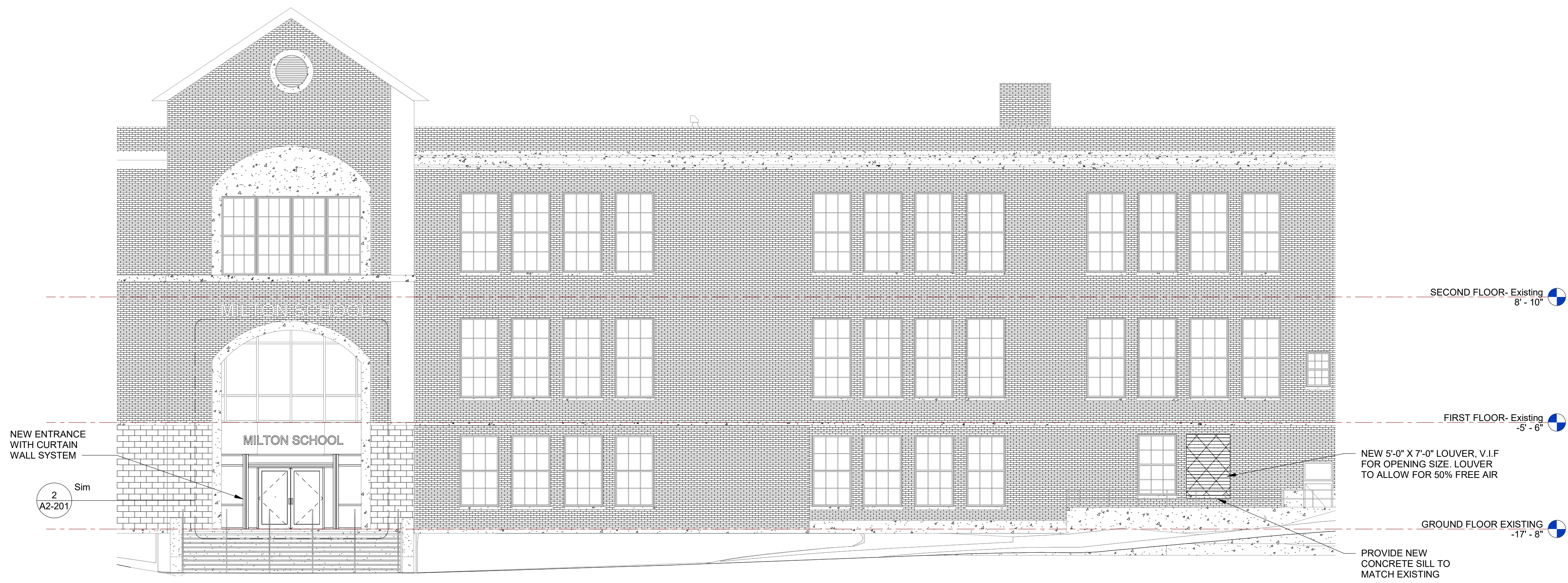
1 Front Elevation SCALE: 1/8" = 1'-0"
