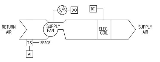
UNIT HEATER - ELECTRIC - SEQUENCE OF OPERATIONS:
