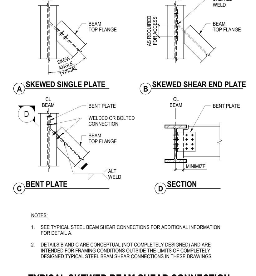
TYPICAL SKEWED BEAM SHEAR CONNECTION
