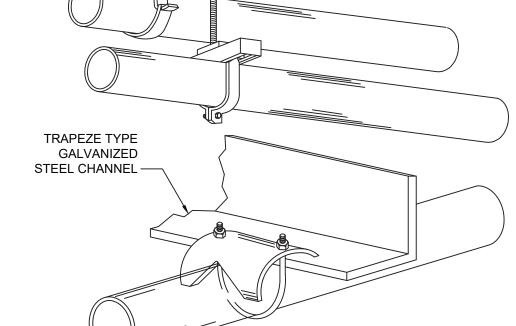
**SUSPENDED SYSTEM SINGLE CONDUIT** 6 SCALE: NTS
