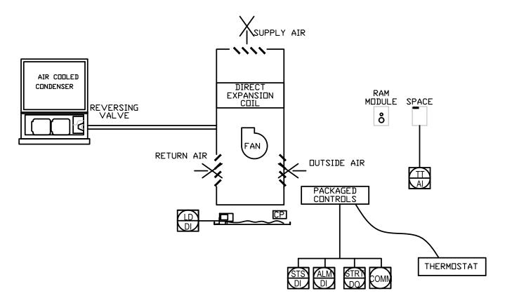
AIR COOLED SPLIT DX VRF HEAT PUMP UNIT TYPICAL
