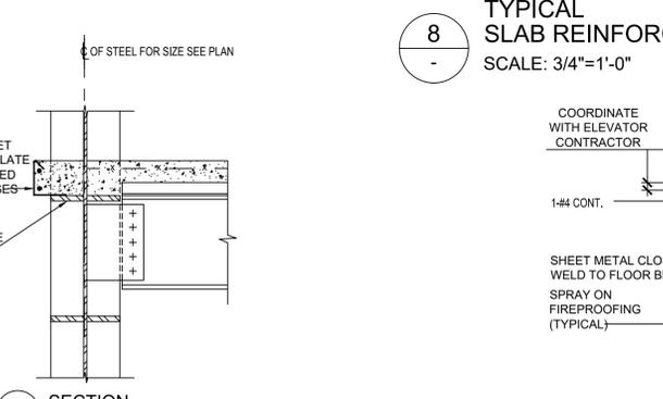
12 TYPICAL SLAB SLAB EDGE AT ELEVATOR SILL
