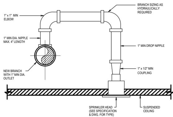
**SPRINKLER HEAD CONNECTION FOR SUSPENDED CEILING**
