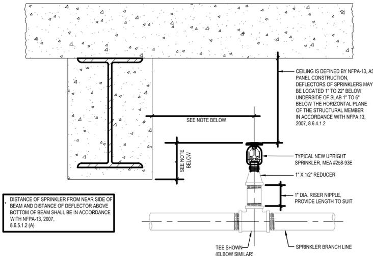
DISTANCE OF SPRINKLER FROM NEAR SIDE OF BEAM AND DISTANCE OF DEFLECTOR ABOVE BOTTOM OF BEAM SHALL BE IN ACCORDANCE WITH NFPA-13, 2007, 8.6.4.1.2
