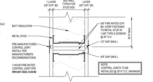
5 GYPSUM BOARD 1-HOUR CONTROL JOINT DETAIL
