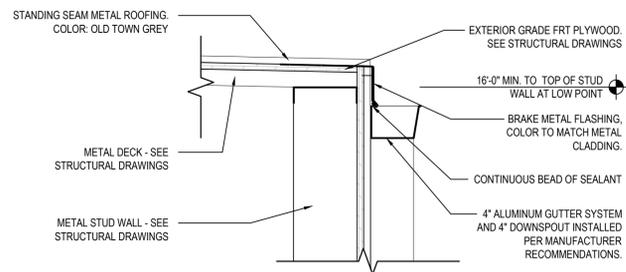
**4 RECEIVING ENCLOSURE GUTTER DETAIL**
