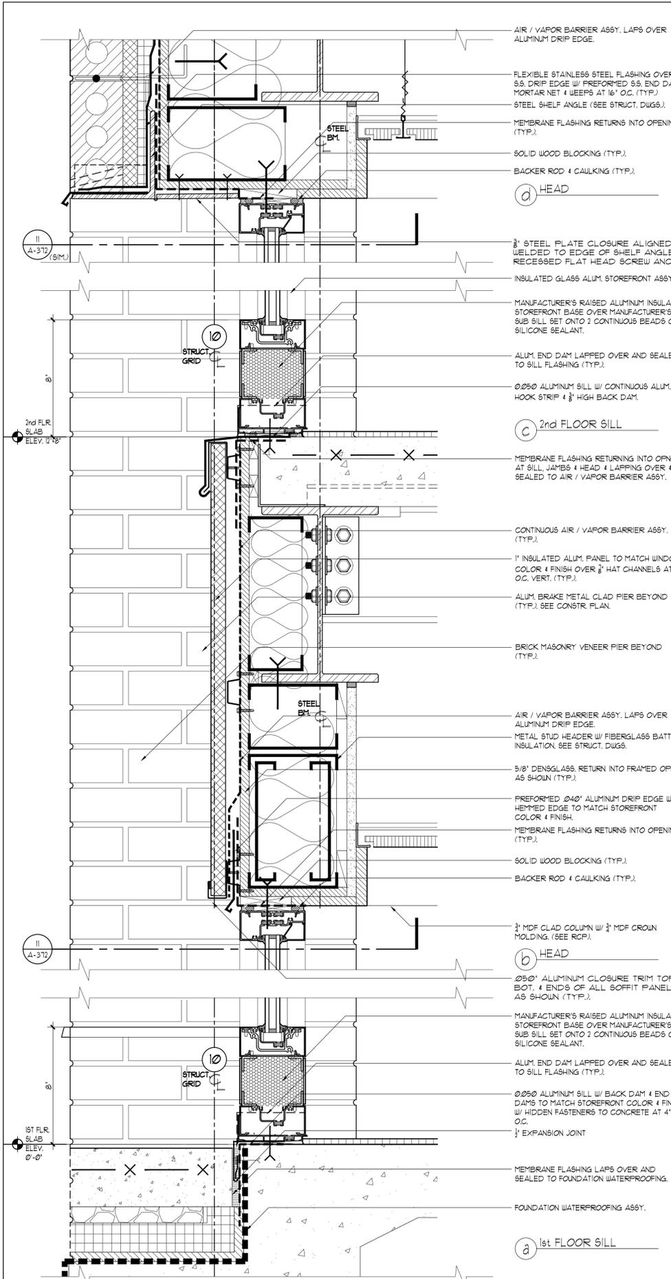
AIR / VAPOR BARRIER ASSY. LAPS OVER ALUMINUM DRIP EDGE.
