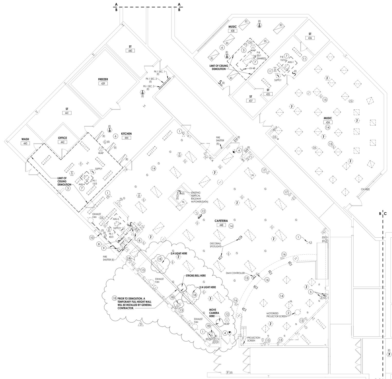
**1 GROUND FLOOR ELECTRICAL DEMOLITION PLAN - AREA B**
