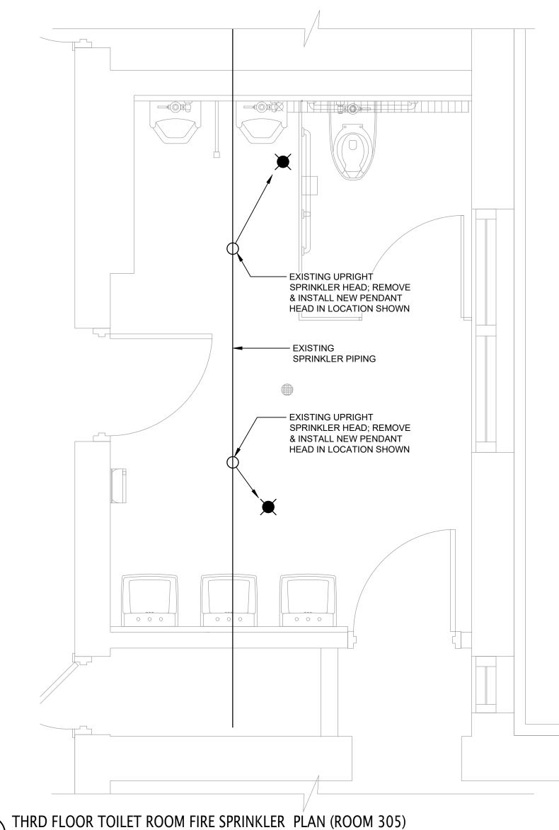
EXISTING UPRIGHT SPRINKLER HEAD; REMOVE & INSTALL NEW PENDANT HEAD IN LOCATION SHOWN SPRINKLER PIPING — EXISTING UPRIGHT SPRINKLER HEAD; REMOVE & INSTALL NEW PENDANT HEAD IN LOCATION SHOWN
