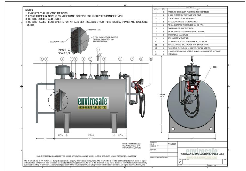
4 500 GALLON DIESEL/GASOLINE STORAGE TANK
