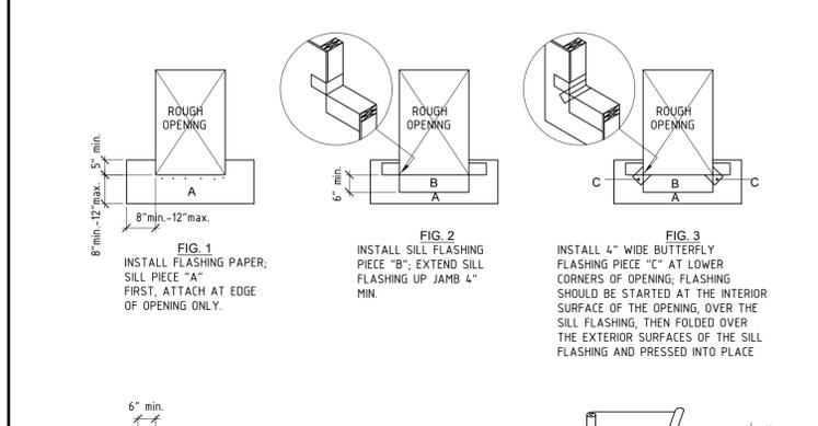
**64 DIAGRAM OF TYPICAL WINDOW FLASHING**
