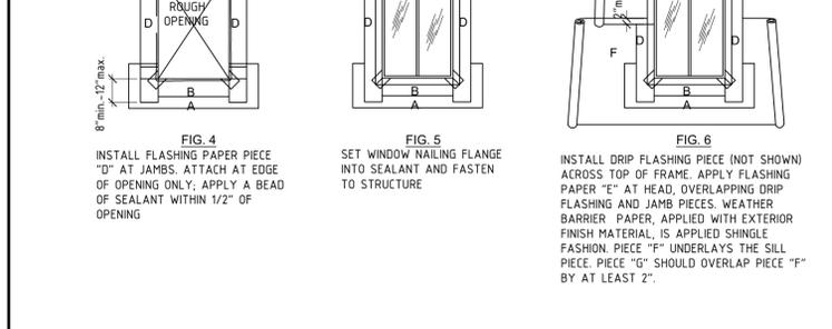
**64 DIAGRAM OF TYPICAL WINDOW FLASHING**
