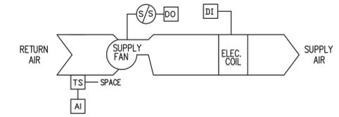
UNIT HEATER - ELECTRIC - SEQUENCE OF OPERATIONS:
