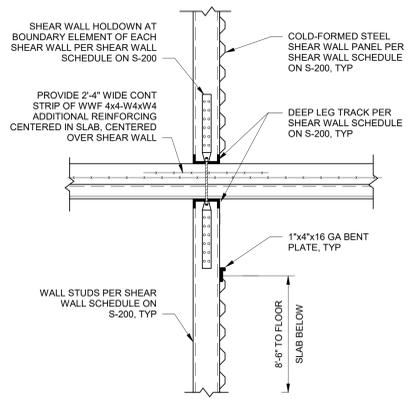
**1 TYPICAL SHEAR WALL HOLDOWN DETAIL**
