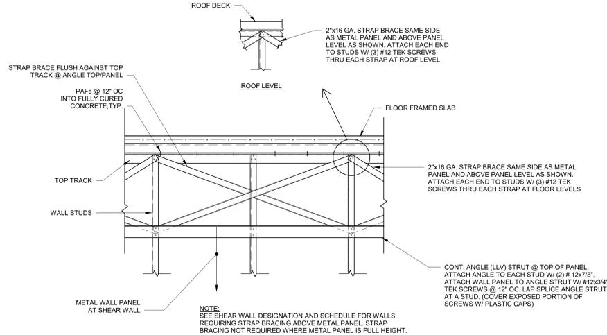
**2 TYPICAL DETAIL @ SHEAR STRAP BRACING ABOVE METAL PANEL**
