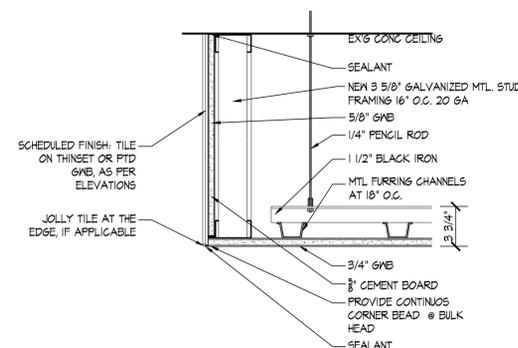
3 SUSPENDED CEILING & SOFFIT DETAIL
