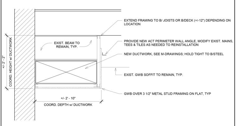
TYPICAL MECHANICAL SOFFIT DETAIL
