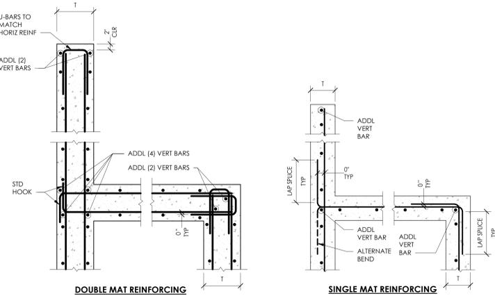
**3 TYPICAL CONCRETE WALL REINFORCING**
