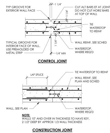
**4 TYPICAL CONCRETE WALL JOINTS**
