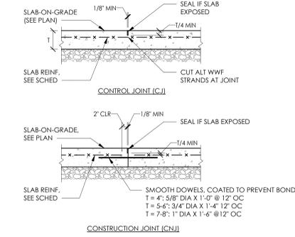
**9 SOG CONTROL/CONSTRUCTION JOINT**
