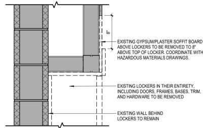
**4B** LOCKER DEMOLITION - SOFFIT
