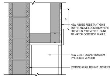
**5B** NEW LOCKER - SOFFIT
