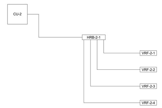
SECOND FLOOR VRF REFRIGERANT PIPING ONE-LINE DIAGRAM
