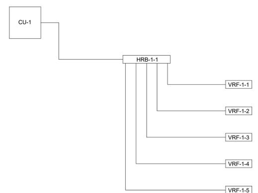
FIRST FLOOR VRF REFRIGERANT PIPING ONE-LINE DIAGRAM
