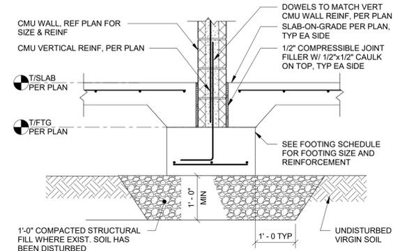
5 TYPICAL FOOTING AT INTERIOR MASONRY WALL
