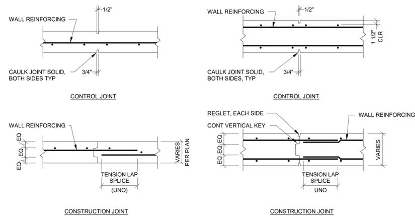
10 TYPICAL CONCRETE WALL JOINT DETAILS
