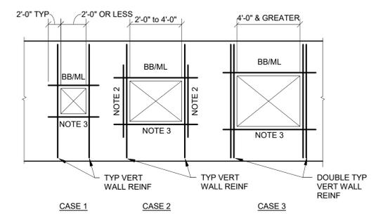
10 TYPICAL REINFORCEMENT AROUND WALL OPENINGS
