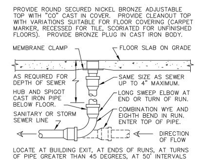
ON STRAIGHT RUNS, AND WHERE SHOWN ON PLANS. PROVIDE BACKFILL PER ARCHITECTURAL SPECIFICATIONS LOCATE CLEANOUTS WHERE THERE IS 18" CLEAR AROUND. CONSULT LOCAL CODES FOR OTHER FCO REQUIREMENTS.
