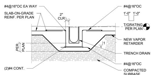
8 TYPICAL TRENCH DRAIN DETAIL @ NEW SLAB
