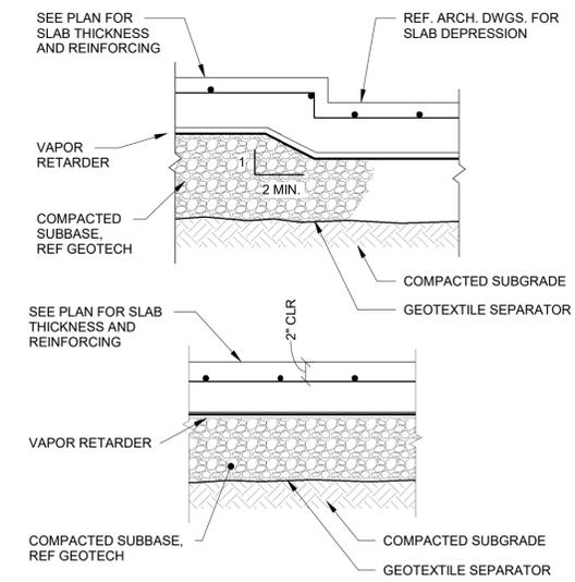
3 TYPICAL SLAB-ON-GRADE CONSTRUCTION
