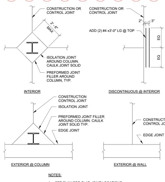
4 TYPICAL SLAB-ON-GRADE JOINT DETAILS
