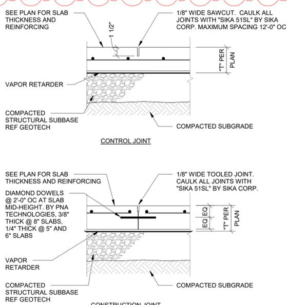
5 TYPICAL SLAB-ON-GRADE JOINTS
